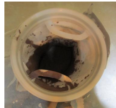
スタッドボルト1本切断後のアブレシブ回収
