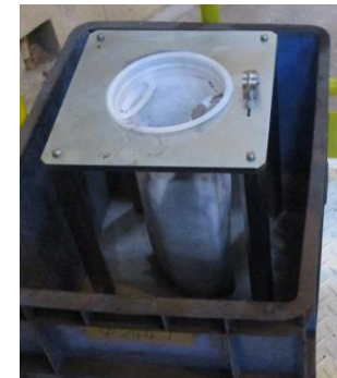
スタッドボルト1本切断後のアブレシブ回収
