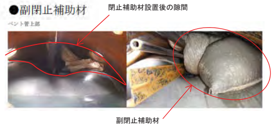
※試験では土嚢袋を使用して、グラウト充填し、隙間部に設置した。
