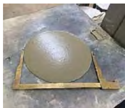
写真8-1 品質確認試験の例 (グラウトの静置フロー)
