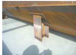
写真19-1 試験装置全景 写真19-2 支持脚周囲の充填 写真19-3 S/C下部の充填
