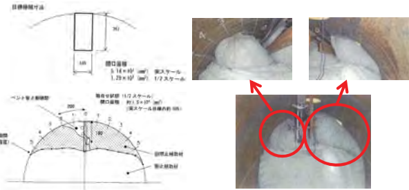
図14-1 閉止補助材設置後の隙間寸法と面積
