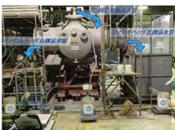
写真15-1 試験体と漏水計測箇所
